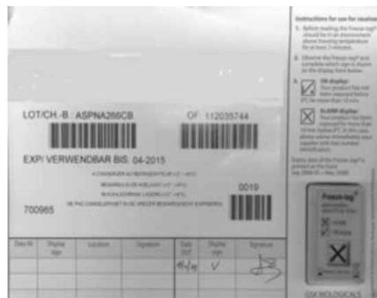
Freeze-tag dont l'écran nous indique qu'il a été exposé à la congélation = Alarme
